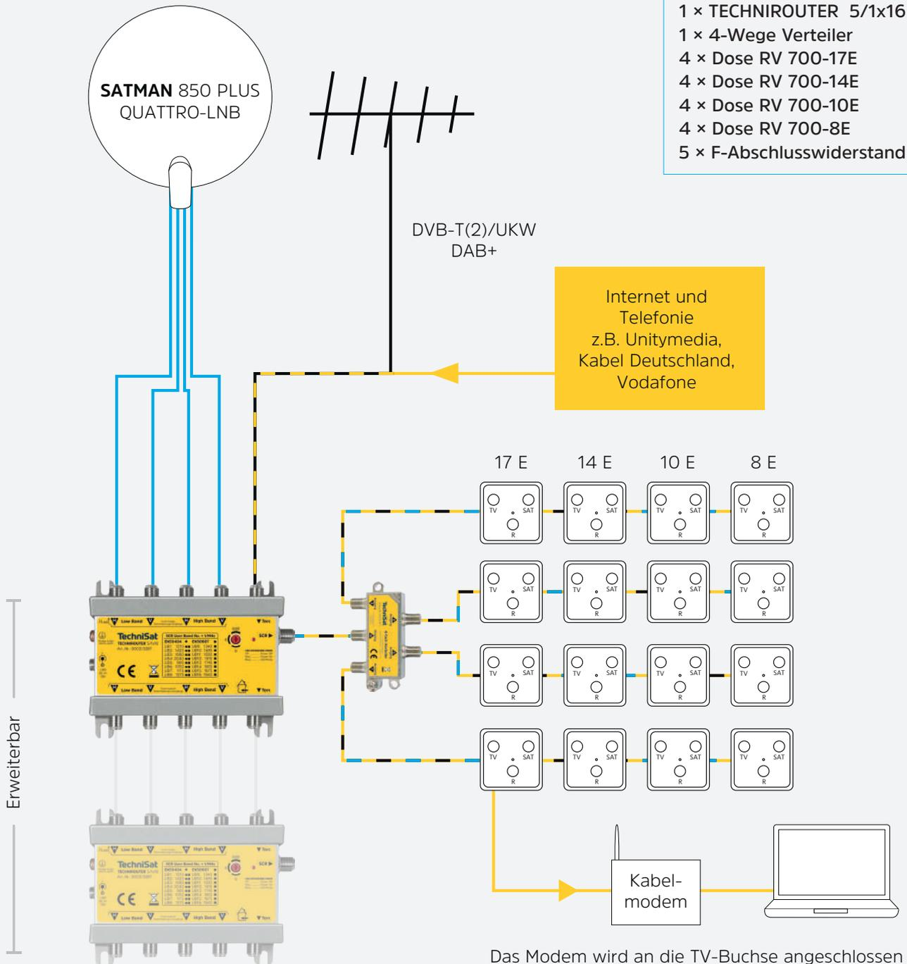
Das Modem wird an die TV-Buchse angeschlossen
